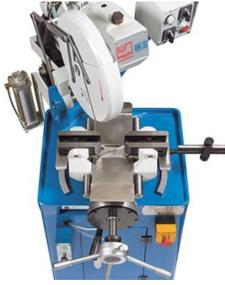
*Prensa de sujeción central neumática*
