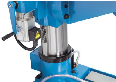
Sollevamento e regolazione altezza tavola di tipo motorizzato
