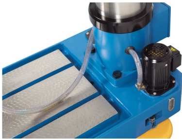
Наклонно-поворотный рабочий стол с большим вылетом
