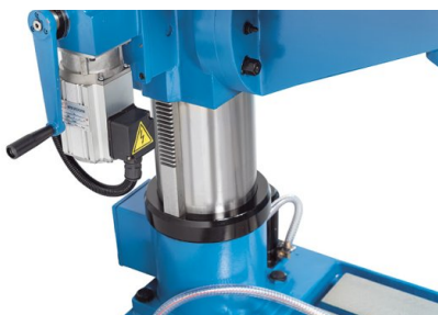
Reglare motorizată a înălțimii mesei de lucru
