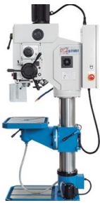
Capacitate de pivotare mare și masă de lucru pivotantă și rotativă
