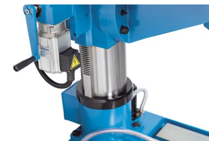
Réglage en hauteur motorisé de la table de travail
