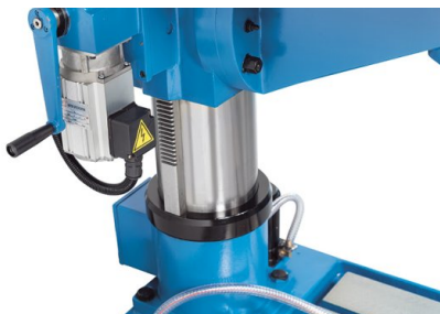
Motorické nastavení výšky pracovního stolu
