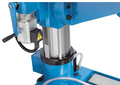
Silnikowa regulacja wysokości stołu roboczego
