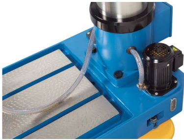
Duży wysięg oraz obrotowy stół roboczy i wychylny
