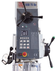
Velocità mandrino, arresto di profondità e posizione cannotto sono indicati sul display digitale
