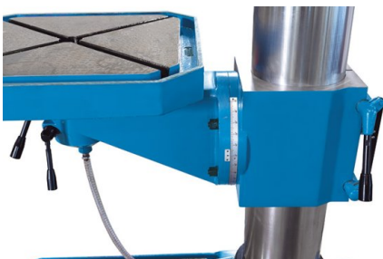
Per fori angolari la tavola è orientabile sino a 45° verso sx e dx
