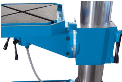
Для сверления под углом стол можно наклонять влево и вправо на угол до 45°
