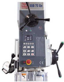
Индикация числа оборотов шпинделя, ограничения глубины и положения пиноли на дисплее
