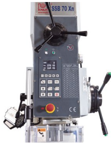
Turația arborelui, opritorul de adâncime și poziția pinolei sunt afișate pe ecran
