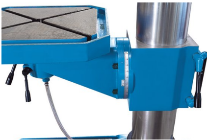
Pour les perçages angulaires, la table est inclinable jusqu'à 45° à droite/à gauche
