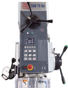
La vitesse de broche, la butée de profondeur et la position du fourreau sont affichées à l'écran
