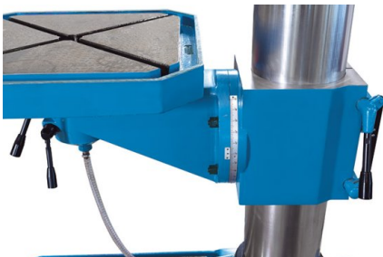
Für Bohrungen im Winkel ist der Tisch um bis zu 45° r+L schwenkbar
