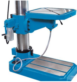
Stół wiertarski jest regulowany na wysokość za pomocą silnika
