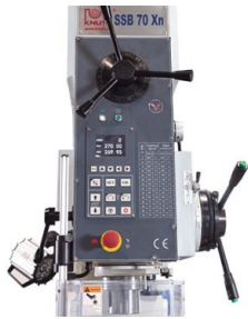
Prędkość obrotowa wrzeciona, ogranicznik głębokości i pozycja pinoli są wyświetlane na wyświetlaczu
