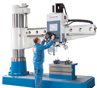
Axele de pivotare și deplasare se remarcă prin mișcare ușoară și ușurează munca operatorului în producția curentă
