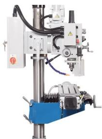
*El cabezal del engranaje y la mesa son ajustables verticalmente*
