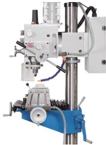
Getriebekopf und Tisch sind höhenverstellbar
