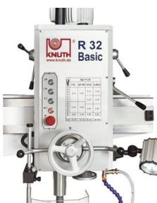
*Le leve d'avanzamento canotto azionano l'avanzamento automatico*
