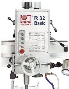
La palanca de mano para alimentación del eje hueco se usa para controlar la alimentación automática.
