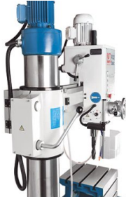
Sujeción mecánica para la cabeza, la columna y el brazo
