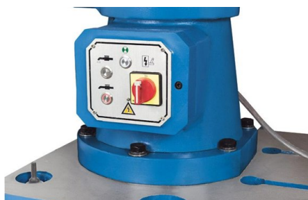
Stabilna baza kolumny z centralnym wyłącznikiem głównym
