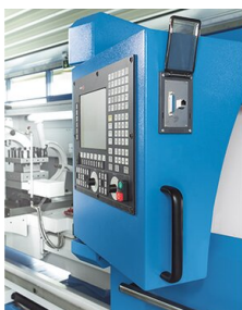
Interface pour la transmission des données, unité de commande pivotante
