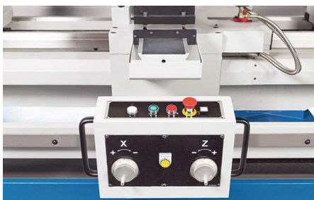
Компактный пульт управления с электронными маховиками
