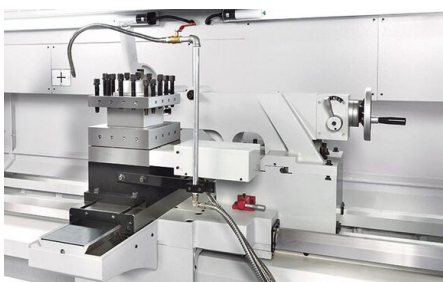
Простое управление: заднюю бабку можно присоединить к суппорту для позиционирования
