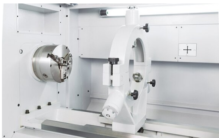
Opțiune: ramă fixă cu diametrul de până la 400 mm
