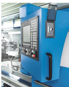
Interfață pentru transfer de date, unitate de comandă pivotantă
