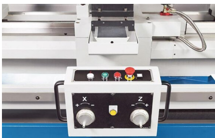
Unité de commande compacte avec manivelles électroniques
