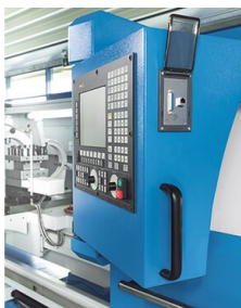
Puerto para la transferencia de datos, panel de control giratorio
