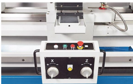
Unidad de control compacta con ruedas manuales electrónicas
