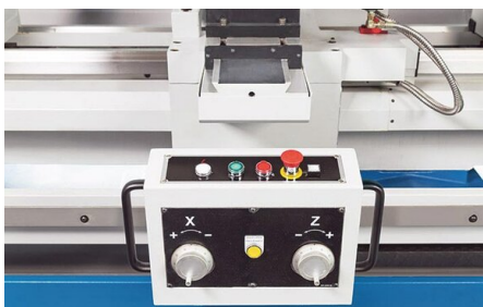
Kompakte Bedieneinheit mit elektronischen Handrädern
