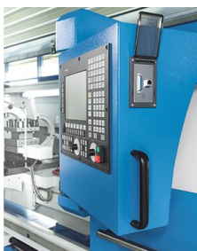
Schnittstelle zur Datenübertragung, schwenkbare Steuerungsbedieneinheit
