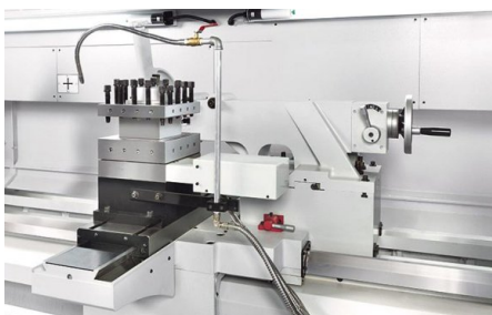
Facilità d'uso: per il posizionamento la contropunta può essere accoppiata al carrello
