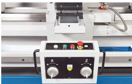
Unité de commande compacte avec manivelles électroniques
