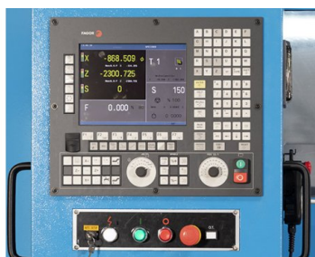
Unité de commande compacte avec manivelles électroniques
