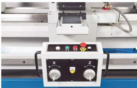
Kompaktní obslužná jednotka s elektronickými ručními kolečky
