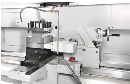
Lehká manipulace: k polohování je možné připojit koník na suport
