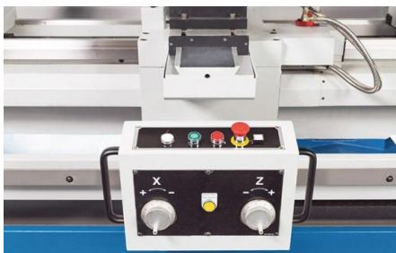
Kompaktowe sterowanie z kółkami elektronicznymi
