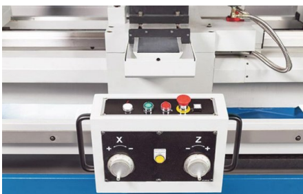
Unità di comando compatta, dotata di volantino elettronico
