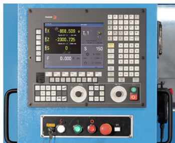
Unità di comando compatta, dotata di volantino elettronico
