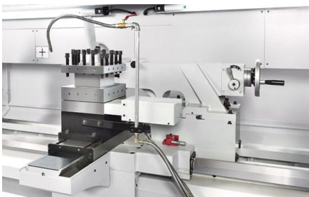
Utilizzo semplice: per il posizionamento è possibile accoppiare la contropunta al carrello
