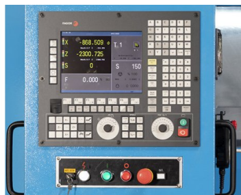
Компактный узел управления с электронными маховичками
