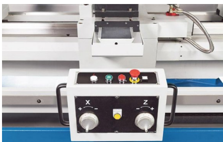
Компактный узел управления с электронными маховичками
