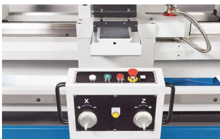
Unitate de control compacta cu roti de mana electronice
