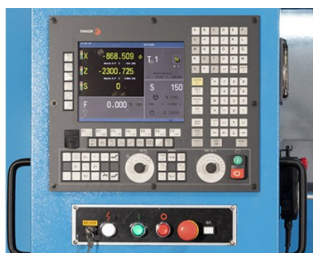
Unitate de control compacta cu roti de mana electronice
