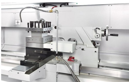
Usor de utilizat: pentru pozitionare papusa mobila poate fi cuplata pe suport
