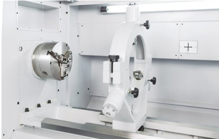
Option: feste Lünette bis zu 400 mm Durchmesser
