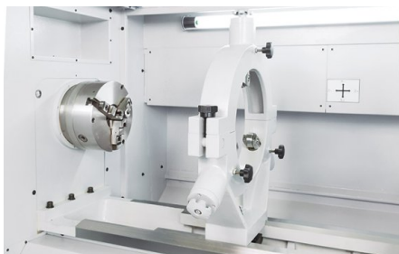
Opcja: stała podtrzymka do 400 mm średnicy
