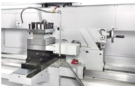
Łatwość obsługi: dla pozycjonowania konik może być sprzężony z supportem
