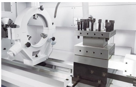
Suport din oțel pentru 4 scule cu schimbare automată
