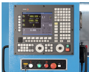
Unité de commande compacte avec manivelles électroniques
