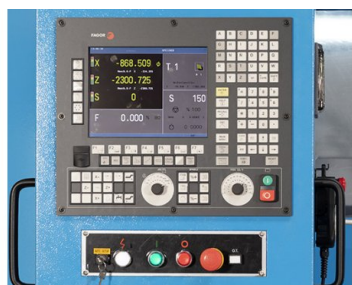
Unità di comando compatta con volantini elettronici
