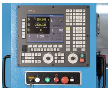
Компактный узел управления с электронными маховичками
