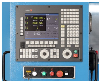
Kompaktní obslužná jednotka s elektronickými ručními kolečky
