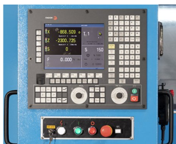
Kompakte Bedieneinheit mit elektronischen Handrädern
