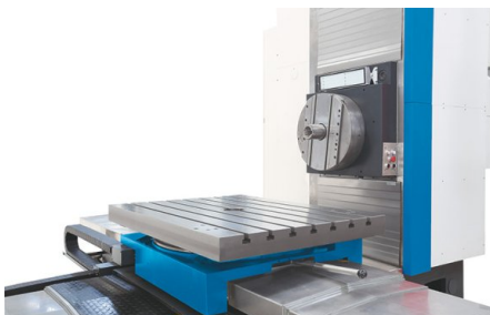
В качестве опции доступны зажимный стол с ручной регулировкой угла и поперечные салазки с ЧПУ
