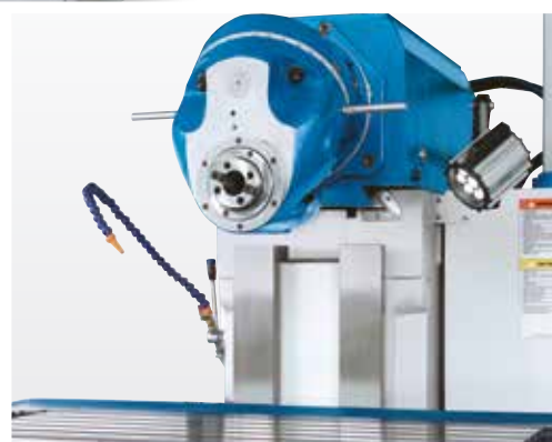
Tête pivotante universelle pouvant être basculée en position horizontale en quelques gestes
