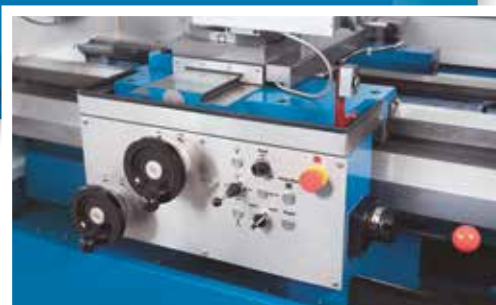
Commande par manivelles électroniques dans le domaine \mu\text{m} – toucher et position comme sur une machine conventionnelle
