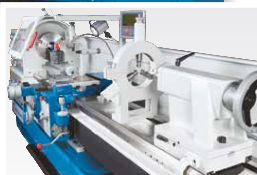
Lunettes fixes pour un usinage précis de pièces longues
