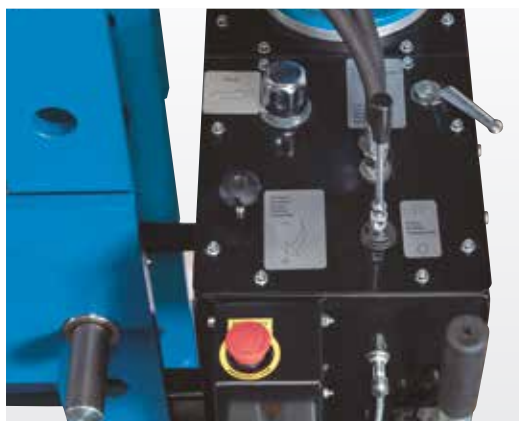
La commande de la presse se fait à l'aide d'un joystick
