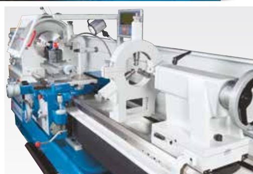
Lünetten zur präzisen Beabreitung langer Werkstücke
