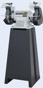
Moderner Doppelschleifbock mit elektronisch regelbarer Drehzahl
